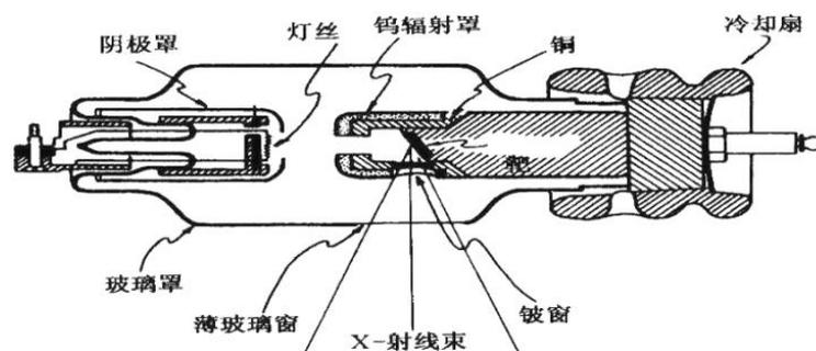
图 9-2 典型 X 线球管示意图
