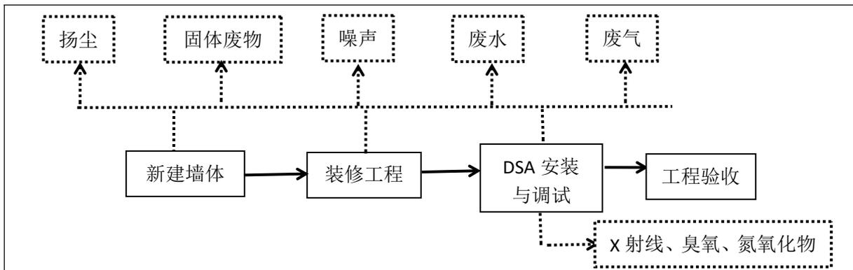
图 9-1 施工期工艺流程及产物环节图
